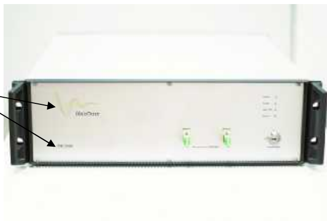
Рисунок 1 - Общий вид анализатора волоконно-оптического распределения температуры и механических напряжений fibrisTerre fTB 2505
