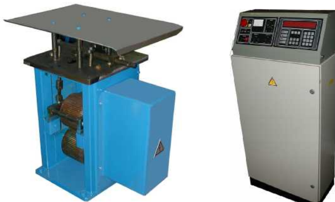
Рисунок 1 - Внешний вид устройства измерений длины протяженных изделий СМ-4 и пульта управления устройством
