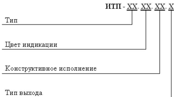
Рисунок 1 - Структура условного обозначения измерителей
