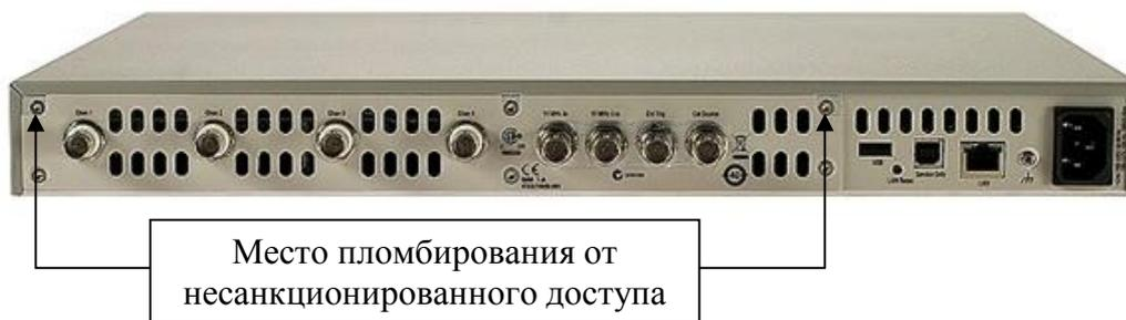
Рисунок 3 - Схема пломбировки от несанкционированного доступа
