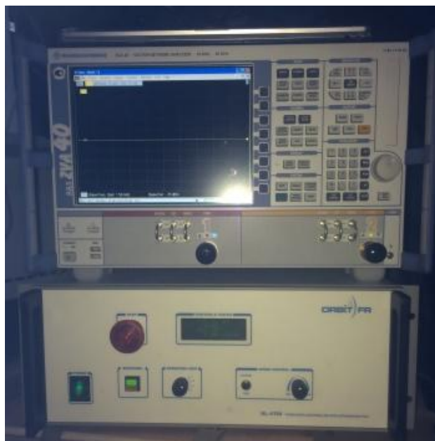
Рисунок 3 - Внешний вид векторного анализатора электрических цепей ZVA 40
