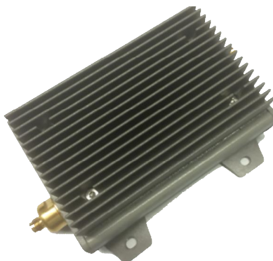
Рисунок 5 - Внешний вид СШП усилителя Agilent 83051A
