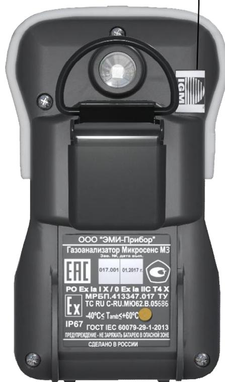
Рисунок 2 - Схема пломбировки от несанкционированного доступа
