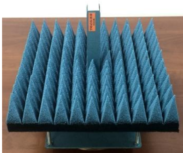
Рисунок 6 - Внешний вид антенны-зонда ТМА3 4-8 И диапазона частот 4 - 8 ГГц (слева), внешний вид антенны-зонда ТМА3 8-18 И диапазона частот 8 - 18 ГГц (справа)
