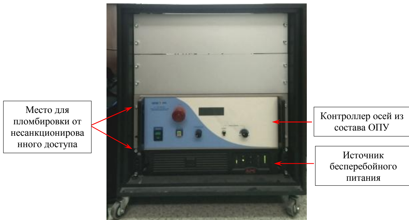
Рисунок 11 - Внешний вид приборной стойки с установленным оборудованием
