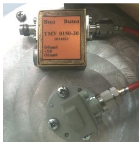
Рисунок 4 - Внешний вид СШП малошумящего усилителя 0,1 - 50 ГГц (слева), внешний вид СВЧ усилителя ТМУ 0150-30 из состава антенны зонда WR-19 (справа)
