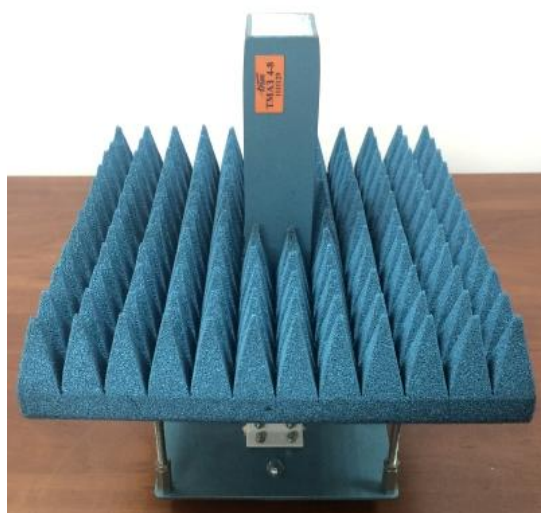
Рисунок 6 - Внешний вид антенны-зонда ТМА3 4-8 И диапазона частот 4 - 8 ГГц (слева), внешний вид антенны-зонда ТМА3 8-18 И диапазона частот 8 - 18 ГГц (справа)
