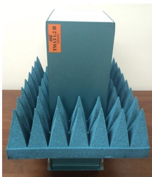
Рисунок 5 - Внешний вид антенны-зонда ТМА3 1-2 И диапазона частот 1 - 2 ГГц (слева), внешний вид антенны-зонда ТМА3 2-4 И диапазона частот 2 - 4 ГГц (справа)
