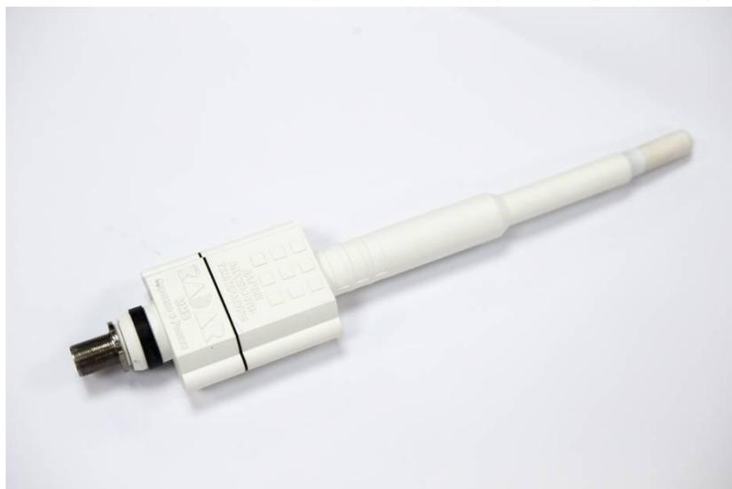
Рисунок 1 - Общий вид датчика ДТВВ-01
