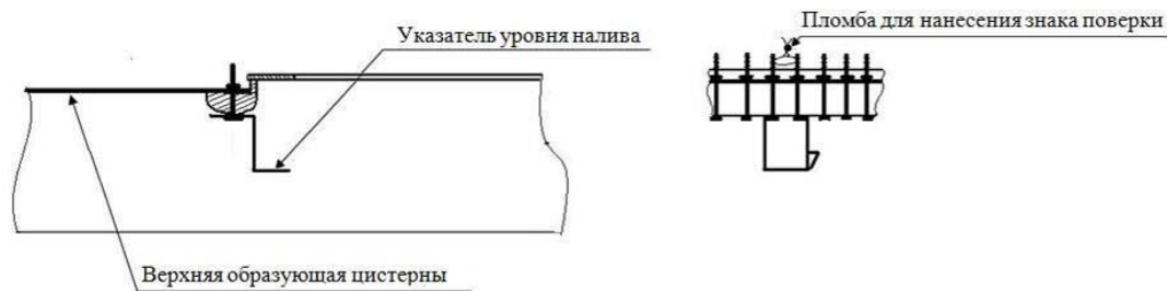
Рисунок 2 - Схема пломбировки от несанкционированного изменения положения указателя уровня налива, обозначение места нанесения знака поверки
