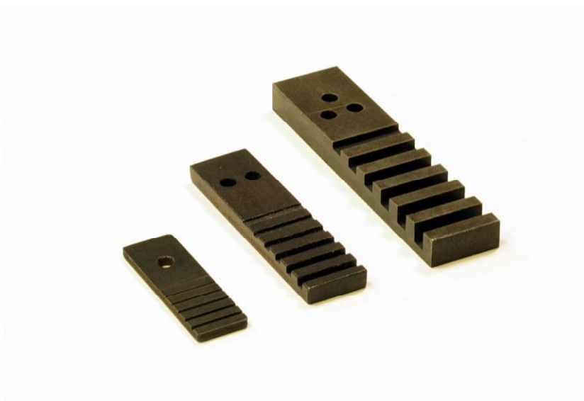
Рисунок 1 - Внешний вид эталонов чувствительности канавочных АРГО (вид сверху)
