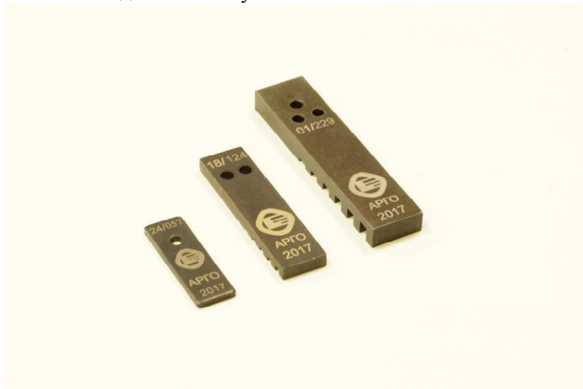
Рисунок 2 - Внешний вид эталонов чувствительности канавочных АРГО (вид снизу)
