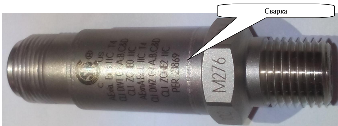
Рисунок 1 - Внешний вид датчика динамического давления ICP модели 102M276
