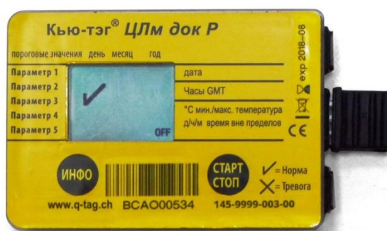
Рисунок 3 - Общий вид термоиндикаторов регистрирующих автономных Q-tag (Кью-тэг) с датчиком температуры модификации Q-tag CLm (Кью-тэг ЦЛм)
