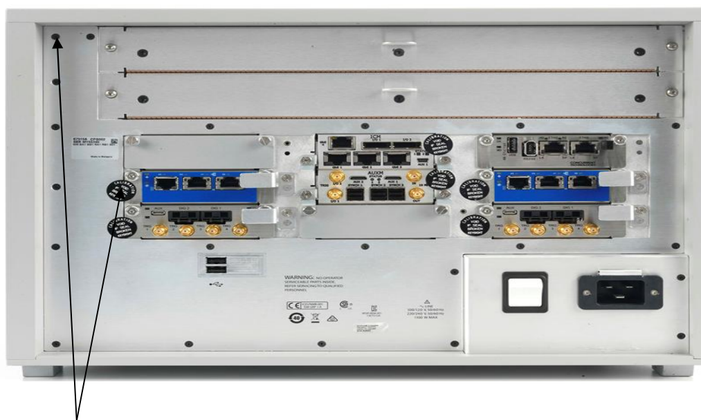
Рисунок 2 - Схема пломбировки от несанкционированного доступа
