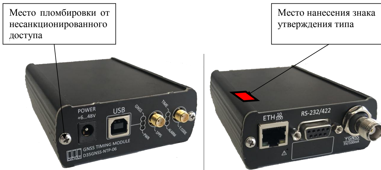
Рисунок 3 - Общий вид и схема пломбировки от несанкционированного доступа СТБ PPS50/DIN35GNSS и PPS100/DIN35GNSS-NTP
