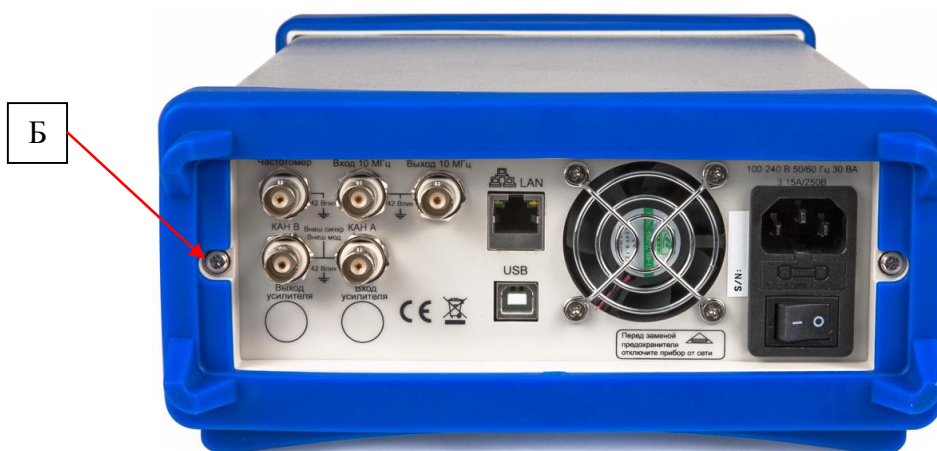
Рисунок 2 - Вид задней панели генераторов и схема пломбировки от несанкционированного доступа (Б)
