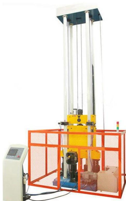
Рисунок 1 - Общий вид копров вертикальных КВ с ручным управлением и обработкой данных с пульта управления
