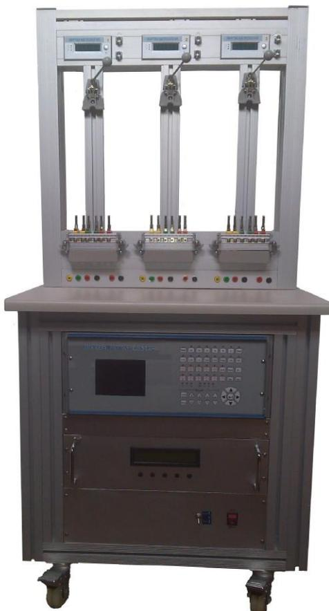
Рисунок 3 - Общий вид трёхфазной установки малогабаритного лабораторного конструктивного исполнения
