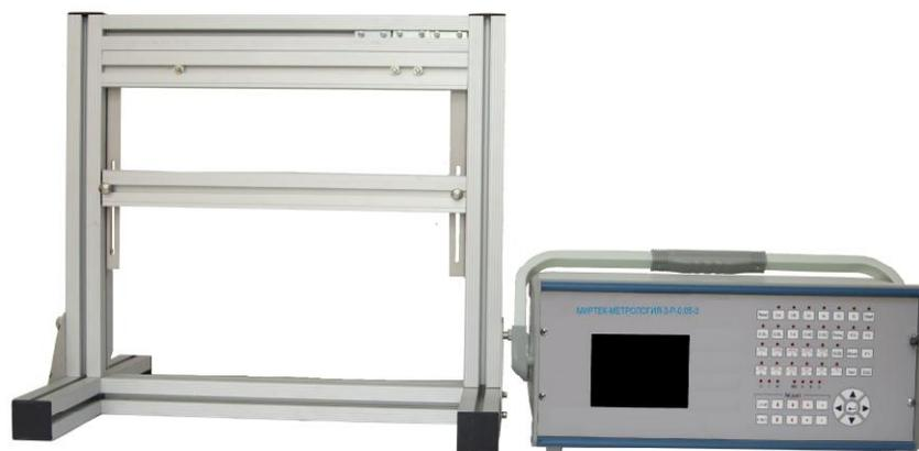
Рисунок 4 - Общий вид трёхфазной установки малогабаритного портативного конструктивного исполнения
