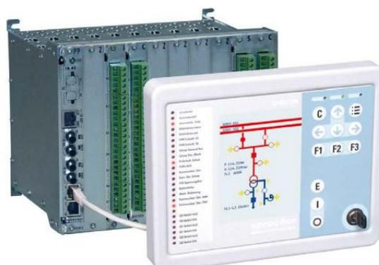
б) вид контроллера с выносной панелью управления
