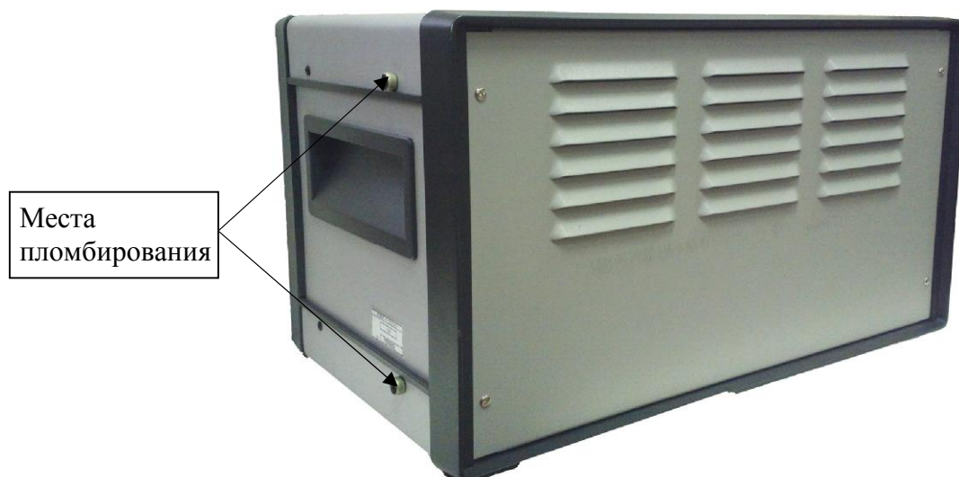
Рисунок 2 - Схема пломбировки субблока измерительного от несанкционированного доступа
