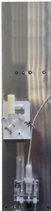
Рисунок 5 - Гидроблок для чистой воды с модулем для поверки и калибровки МПК-01 для блоков ЛИДЕР-О<sub>2</sub> и ЛИДЕР-Н<sub>2</sub>
