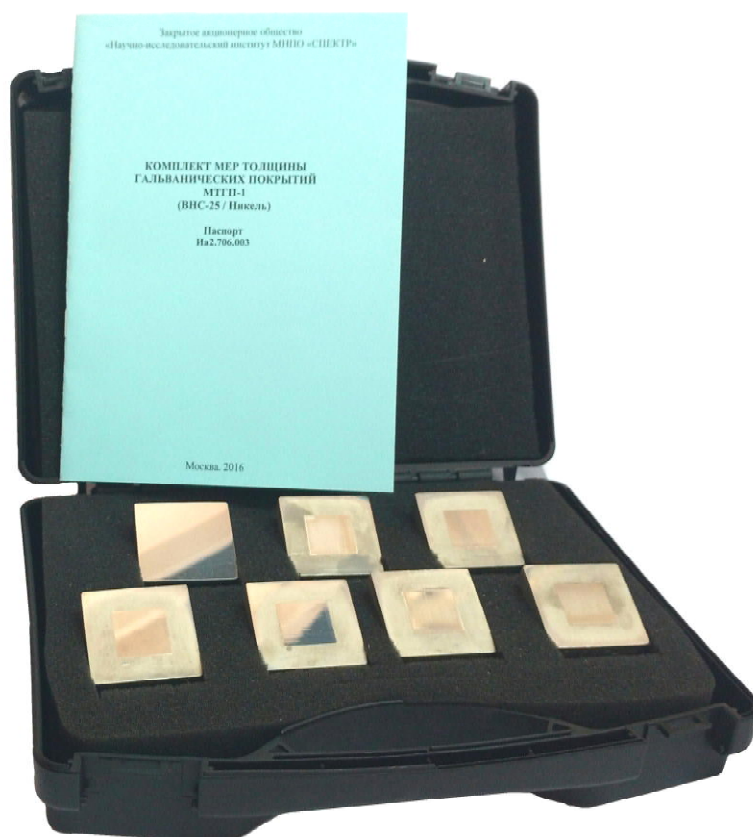
Рисунок 1 - Общий вид комплекта мер толщины гальванических покрытий МТПП-1 (ВНС-25/Никель)
