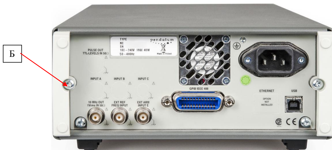
Рисунок 2 - Вид задней панели частотомеров и схема пломбировки от несанкционированного доступа (Б)
