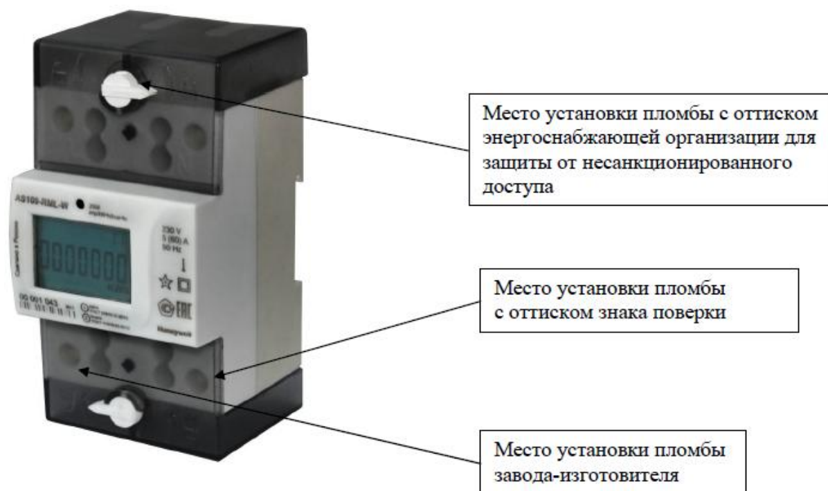
Рисунок 1 – Общий вид счетчика, схема пломбировки от несанкционированного доступа, обозначение места нанесения знака поверки
