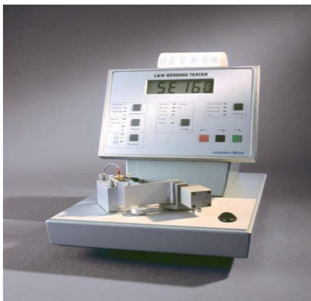
Рисунок 1 - Общий вид приборов для определения сопротивления изгибу SE 160
