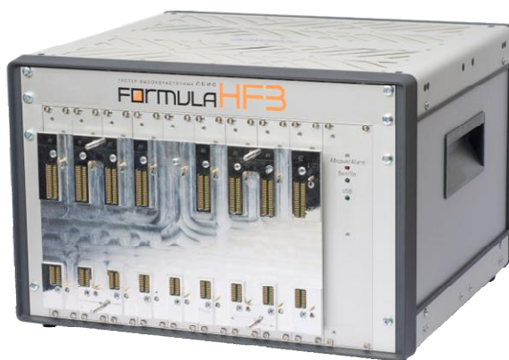
Рисунок 1 - Общий вид измерительного блока Тестеров FORMULA HF2, FORMULA HF3 и FORMULA HF3M
