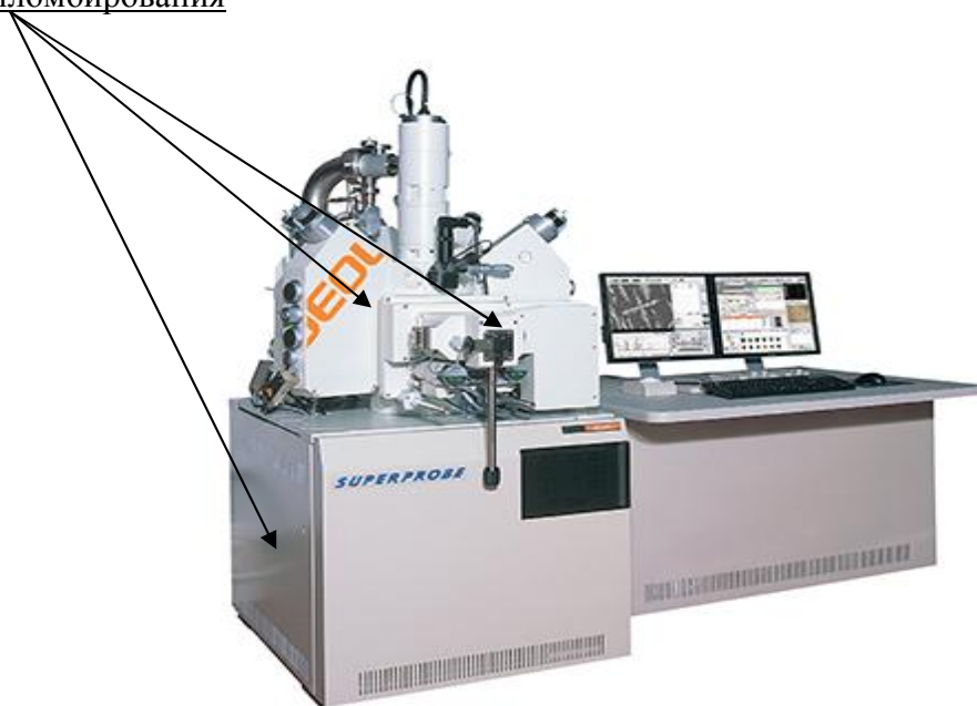
Рисунок 2 - Схема пломбировки от несанкционированного доступа
