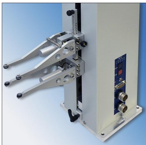
Рисунок 1 - Внешний вид датчиков перемещений (деформаций) MFE-900
