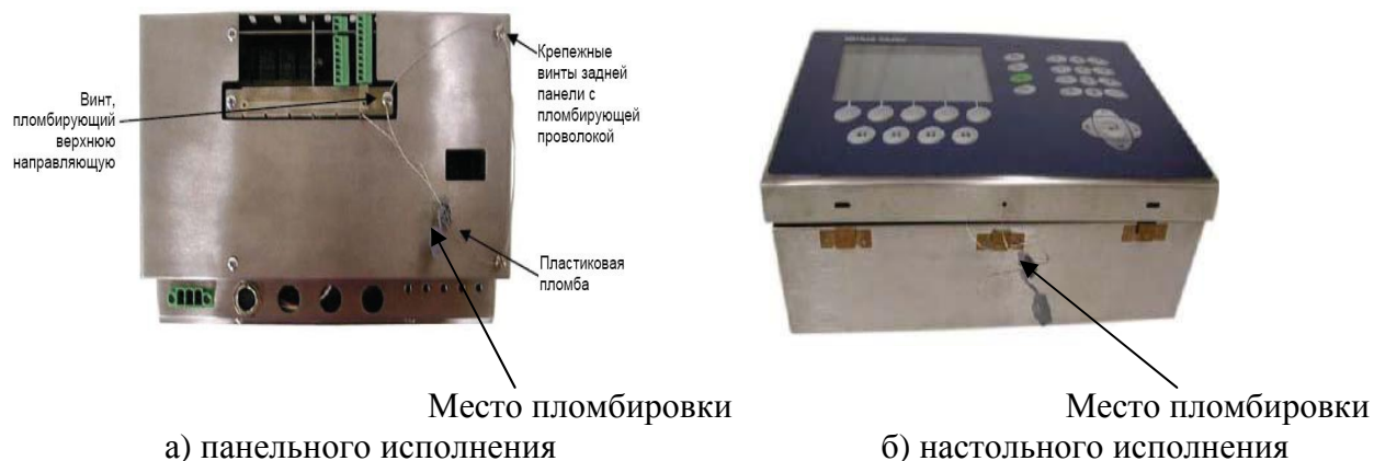
Рисунок 4 - Место пломбировки терминалов панельного и настольного исполнений
