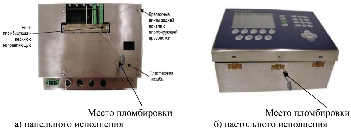
Рисунок 4 - Место пломбировки терминалов панельного и настольного исполнений
