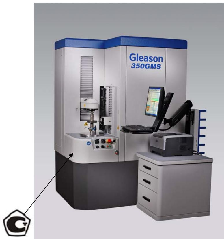
Рисунок 2 - Внешний вид систем зубоизмерительных серии GMS
