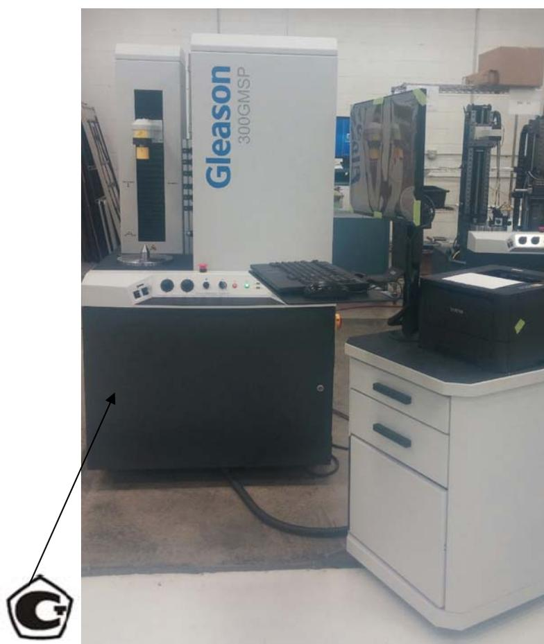
Рисунок 3 - Внешний вид систем зубоизмерительных серии GMSP
