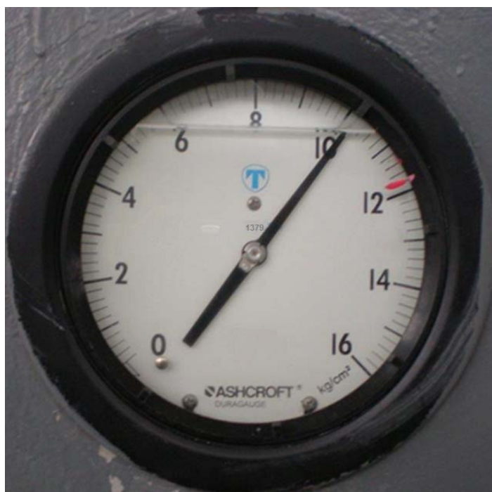
Рисунок 1 - Общий вид манометров промышленных "ASHCROFT" модели 1379
