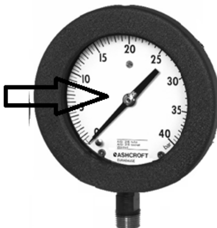
Рисунок 2 - Обозначение места нанесения знака поверки на манометры
