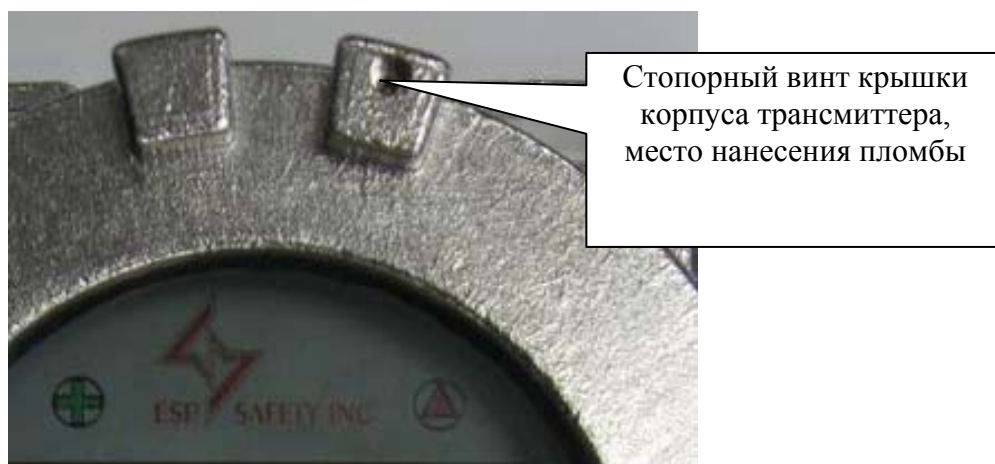
Рисунок 2 - Схема пломбировки газоанализаторов от несанкционированного доступа
