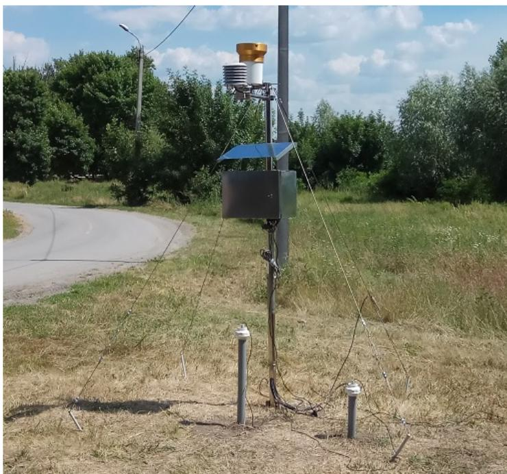
Рисунок 1 - Общий вид комплекса агрометеорологического АИП 1
