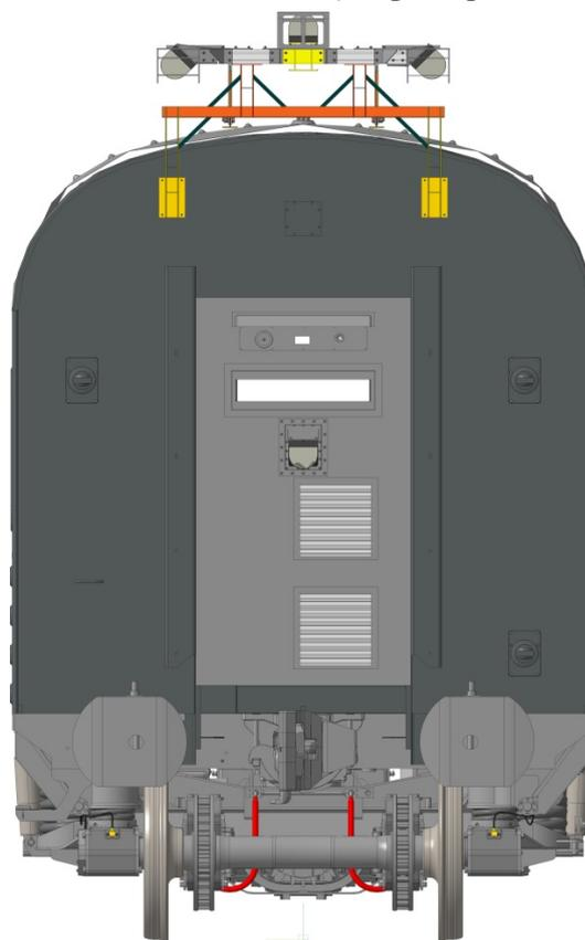
Рисунок 2 - Схематичное расположение Систем скоростного и высокоскоростного трехмерного сканирования «Габарит-М» на вагоне
