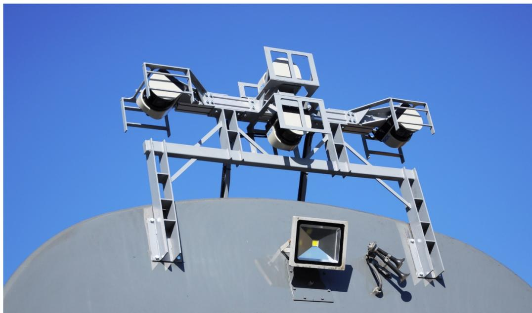
Рисунок 1 - Общий вид систем скоростного и высокоскоростного трехмерного сканирования «Габарит-М» установленных на вагоне (на фото рама с датчиками системы)
