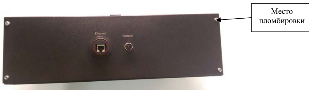
Рисунок 2 - Схема пломбировки от несанкционированного доступа
