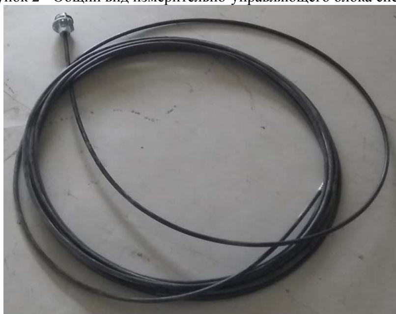
Рисунок 3 - Общий вид термоподвесок
