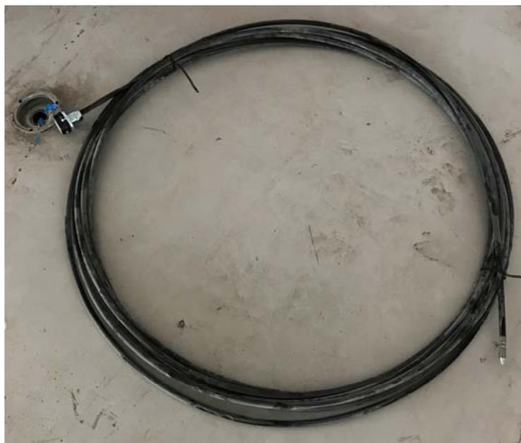
Рисунок 2 - Общий вид термоподвесок
