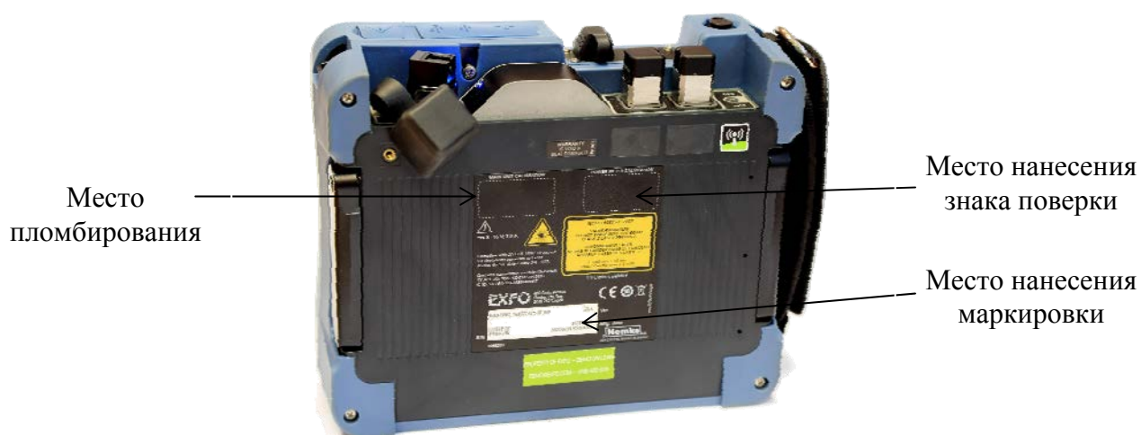
Рисунок 2 - Схема пломбировки от несанкционированного доступа, обозначение места нанесения знака поверки и маркировки
