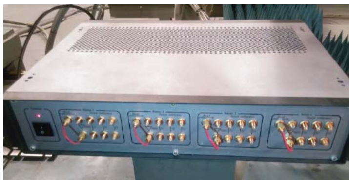
Рисунок 5 - Конструкция и внешний вид четырехканального стробоскопического приемного модуля
