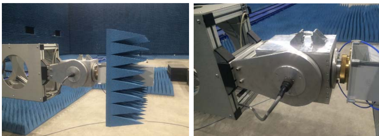
Рисунок 3 - Общий вид оси Z сканера AL-4953-1-13m-13m-V-S с установленной антенной-зондом ТМАЗ 1-2 И
