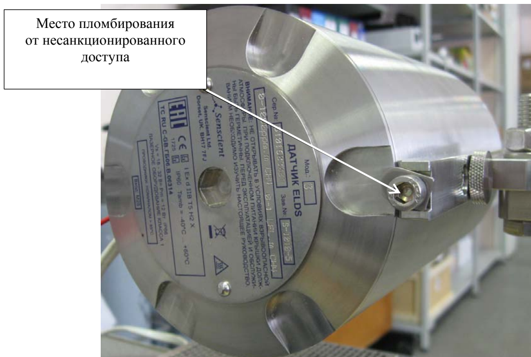
Рисунок 2 - Схема пломбирования газоанализаторов от несанкционированного доступа
