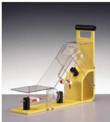
Рисунок 1 - Прибор для контроля чистоты углекислого газа СРТ
