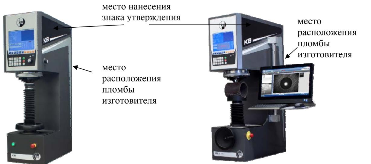
Твердомеры KV 250, KV 750, KV 1000
