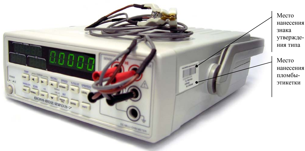
Рисунок 1 - Внешний вид миллиомметра цифрового GOM-802/2203-7
