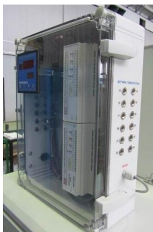
Рисунок 4 - Шкаф измерительный температуры
