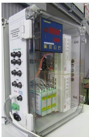
Рисунок 3 - Шкаф измерительный датчиков 4...20
