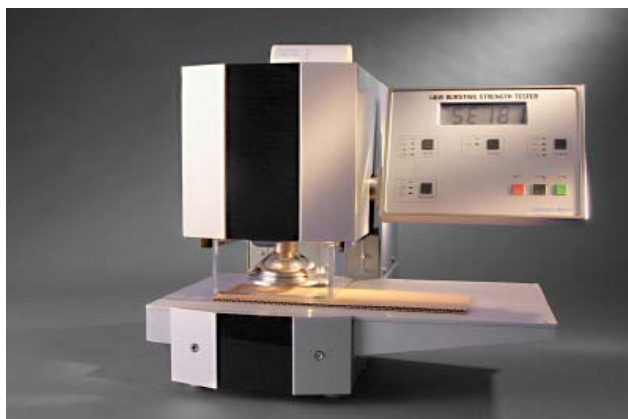
Рисунок 1 - Внешний вид приборов для определения сопротивления продавливанию SE 180, SE 181
