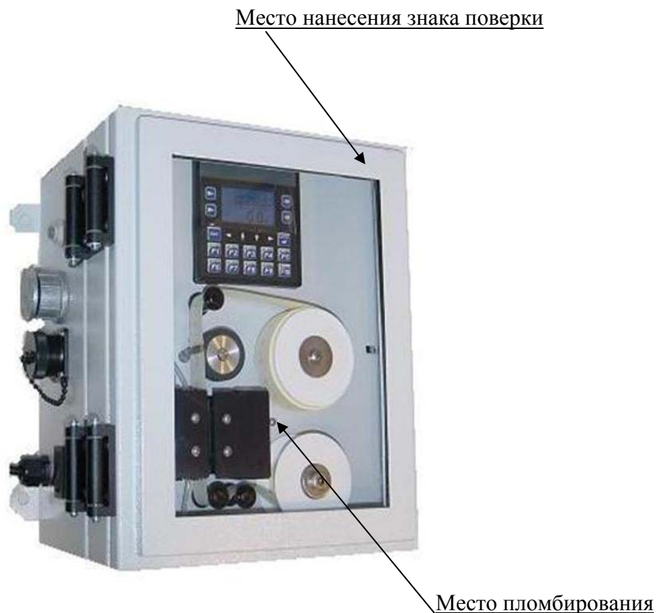
Рисунок 1 - Общий вид газоанализатора ChemLogic 1 модели CL1 (МДИ)
