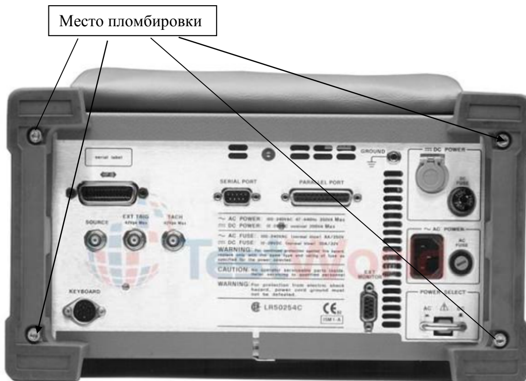
Рисунок 2 - Задняя панель анализатора. Места пломбировки от несанкционированного доступа
