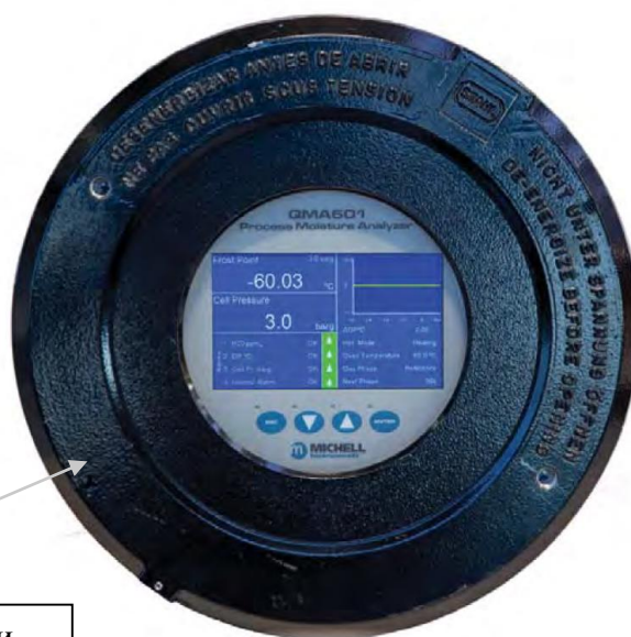
Рисунок 1 - Общий вид QMA601 SN и схема обозначения места нанесения знака поверки
