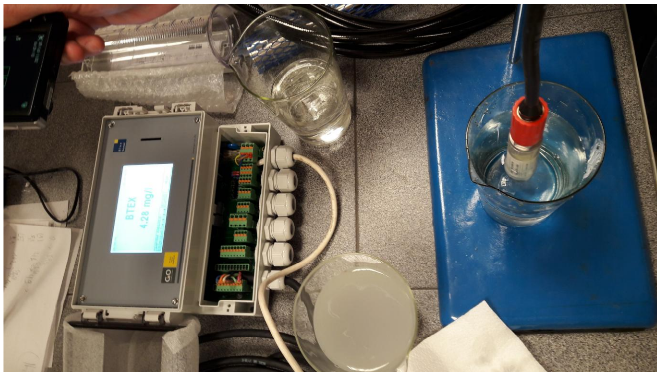
Рисунок 1 - Общий вид анализатора в конфигурации (вычислительный модуль BlueSense - погружной датчик нефтепродуктов)
